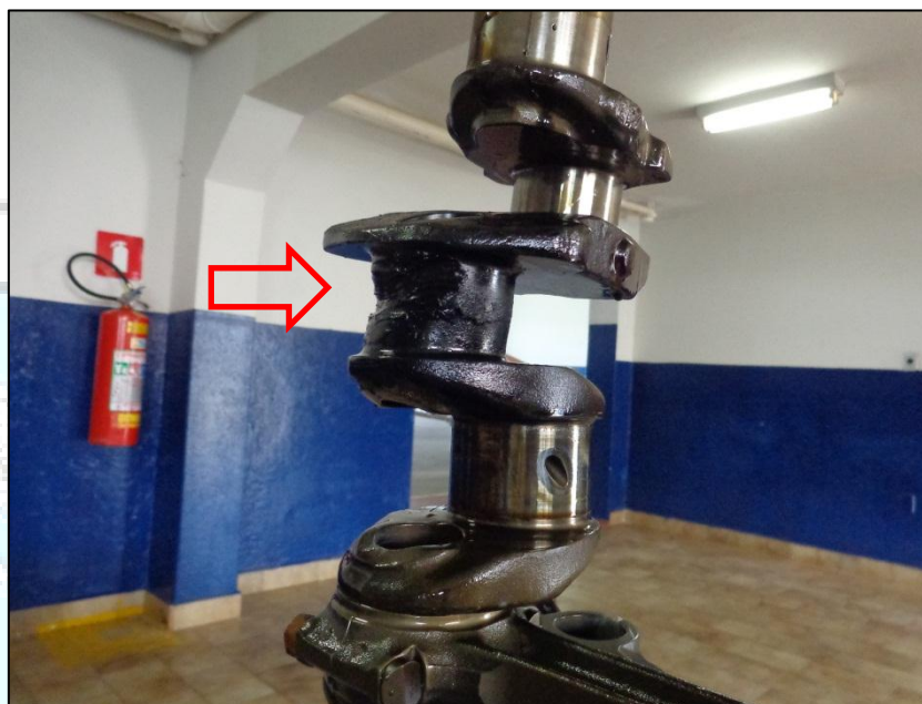
Figura 4 - Vista da árvore de manivelas com o moente do cilindro 4 danificado.
