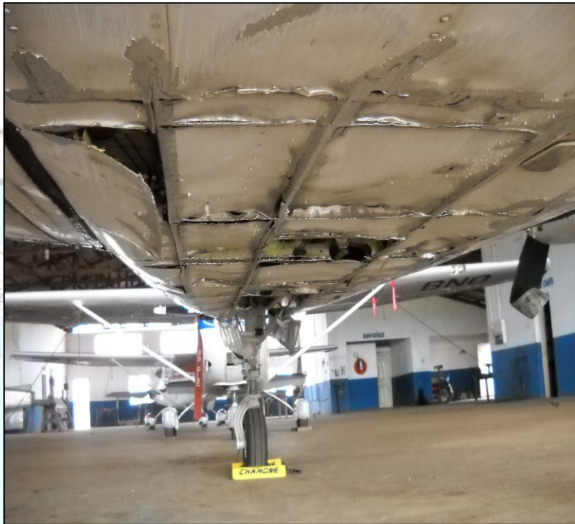
Figura 2 - Detalhe da condição da aeronave em virtude do pouso sem trem.
