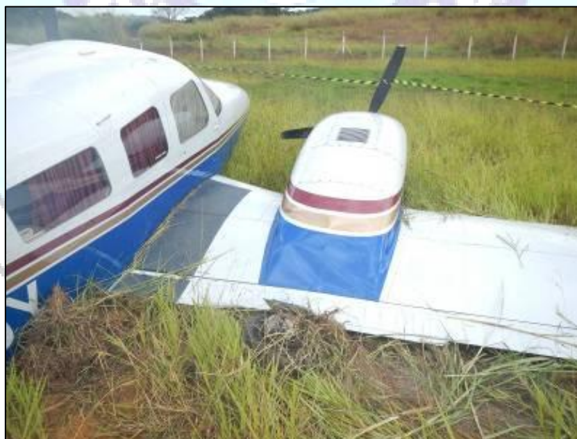
Figura 2 - Vista da asa direita e trem de pouso direito danificado.
