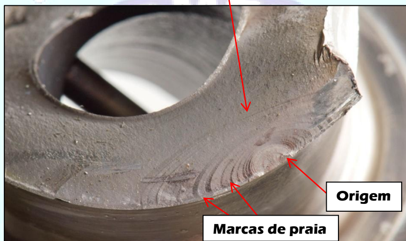
Figura 8 - Detalhe da região de início da fratura: observam-se marcas de praia indicativas de fadiga.
