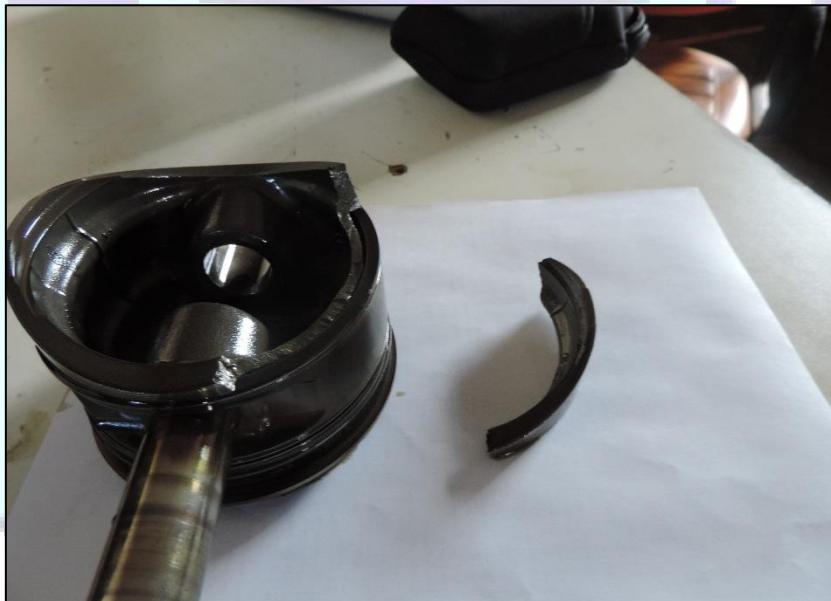
Figura 6 – Pistão nº 3 fraturado.
