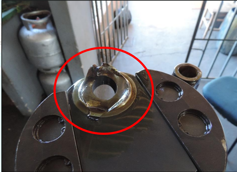
Figura 5 – Eixo de manivelas fraturado.
