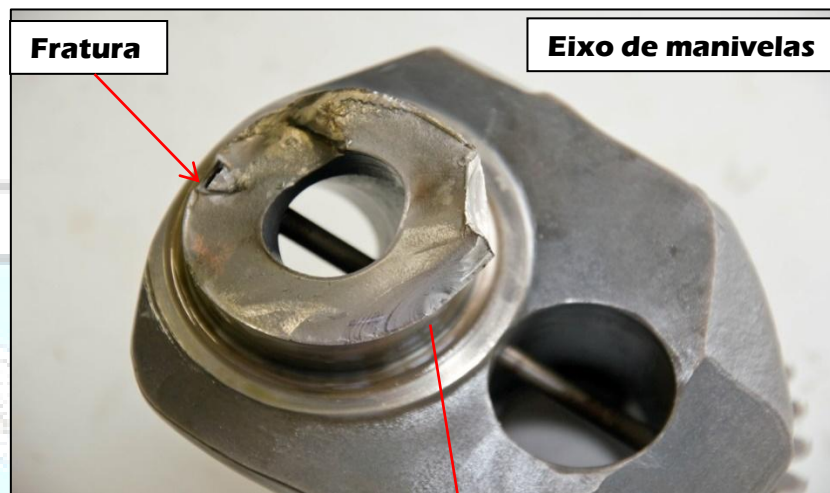
Figura 7 – Vista geral da fratura
