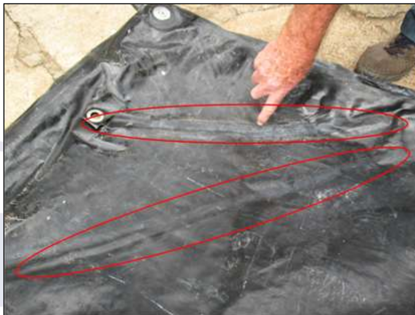
Figura 2 - Enrugamento na célula de combustível.
