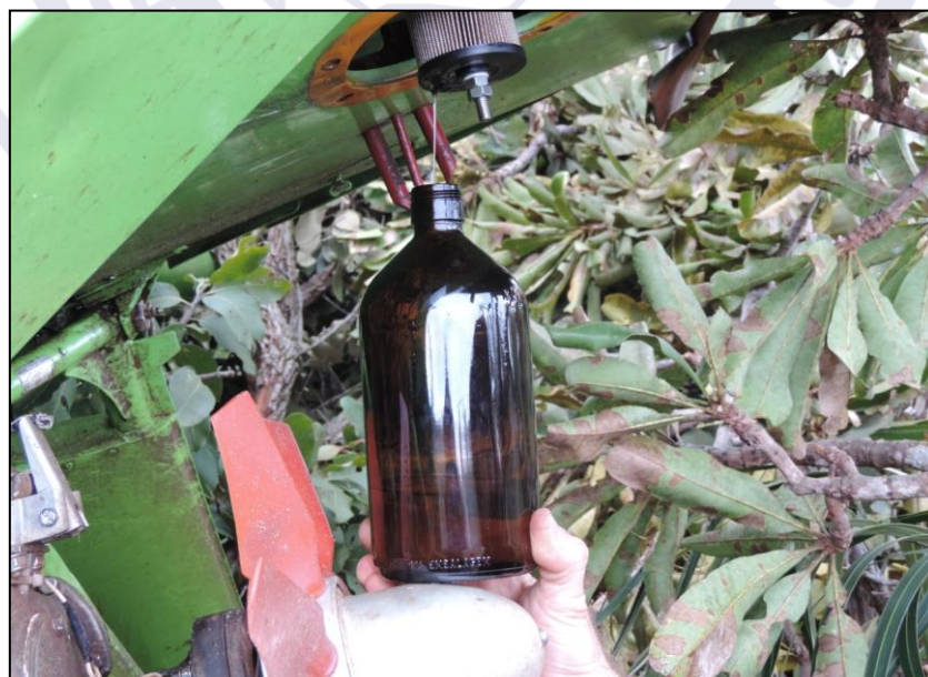
Figura 3 - Coleta de combustível remanescente do filtro.
