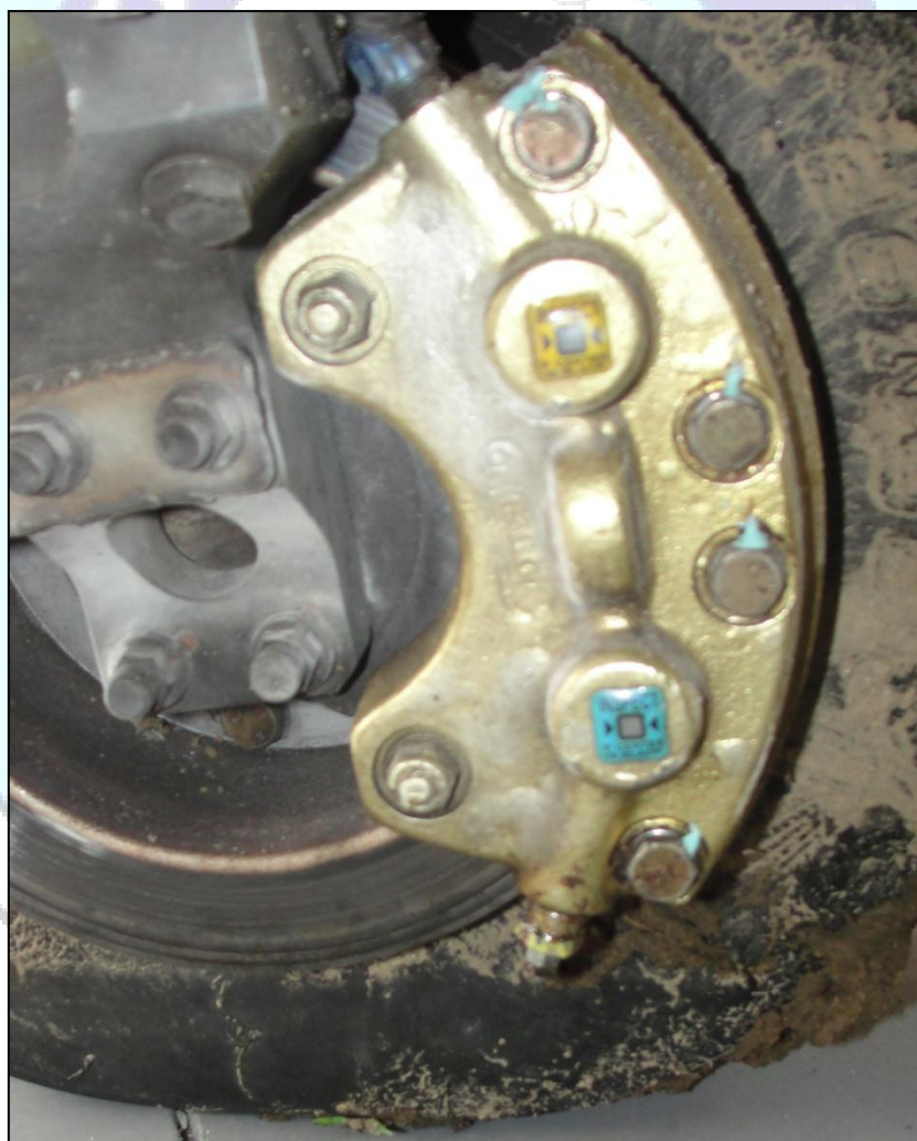
Figura 3 – Indicadores de superaquecimento do freio direito escurecidos.
