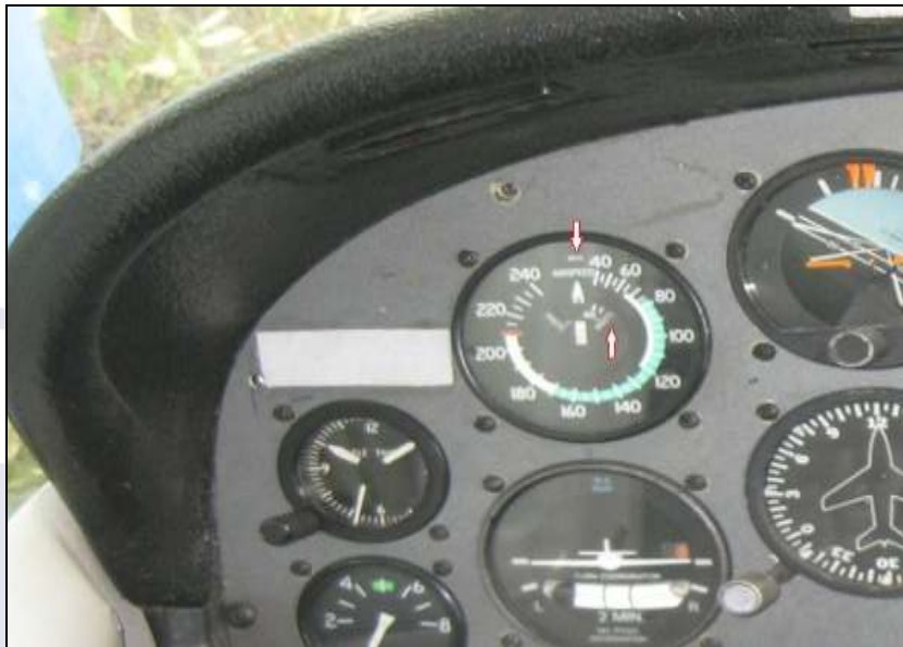
Figura 3 – Velocímetro com indicação em MPH e KNOTS.
