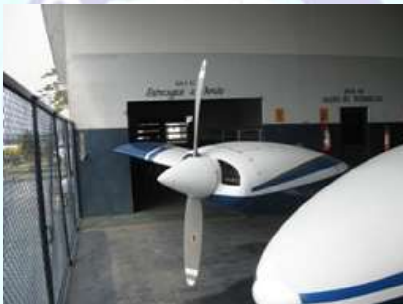
Figura 2 - Hélice do motor direito empenada.
