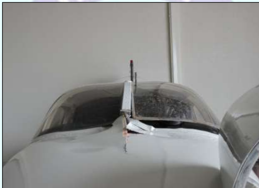
Figura 4 - Em função do impacto contra o solo, houve quebra do trem de pouso do nariz e perfuração da parte superior dianteira da fuselagem.
