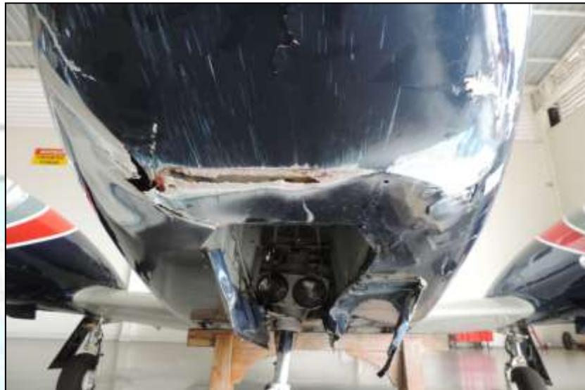
Figura 3 - Danos na parte dianteira da fuselagem e portas do trem de pouso do nariz.
