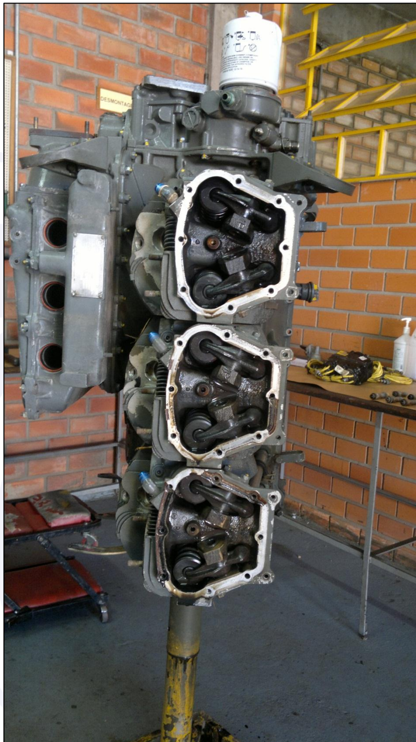
Figura 3 – Vista do início da abertura do motor.
