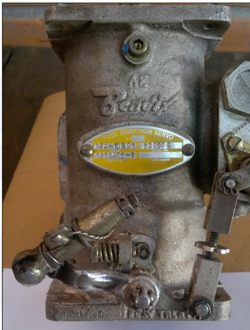
Figura 5 – Injetora de Combustível.
