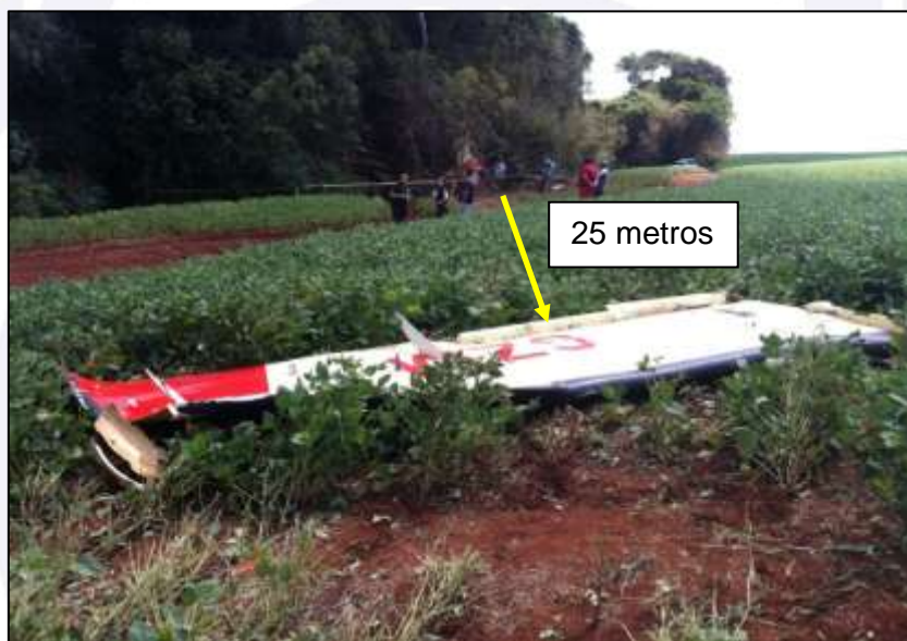
Figura 2 – Asa esquerda localizada 25 metros antes dos destroços.
