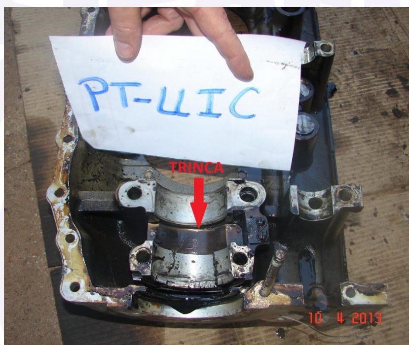
Figura 3 – Trinca no mancal frontal.
