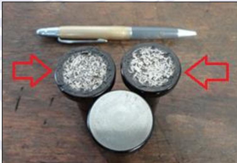
Figura 3 - Capas de tucho danificadas ao lado de uma capa nova.
