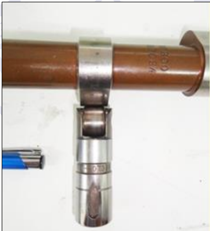
Figura 5 - Tucho roletado em contato com o came do eixo de ressaltos.
