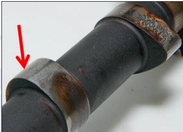
Figura 2 - Detalhe do desgaste no comando de válvulas.
