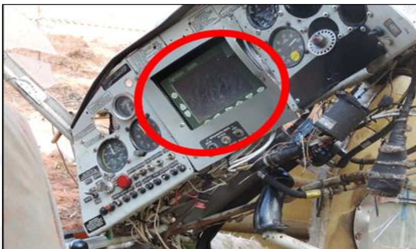
Figura 17 - Painel da aeronave. Em destaque, a tela do DGPS retirada para degravação.
