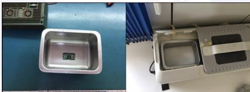
Figura 23 - Processos de limpeza química e por ultrassom da memória SRAM retirada da tela AG-NAV GUIA.
