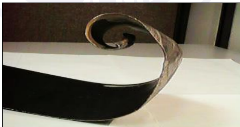
Figura 37 - Pá de hélice curvada para frente como resultado de alta RPM durante um impacto com baixo ângulo.
