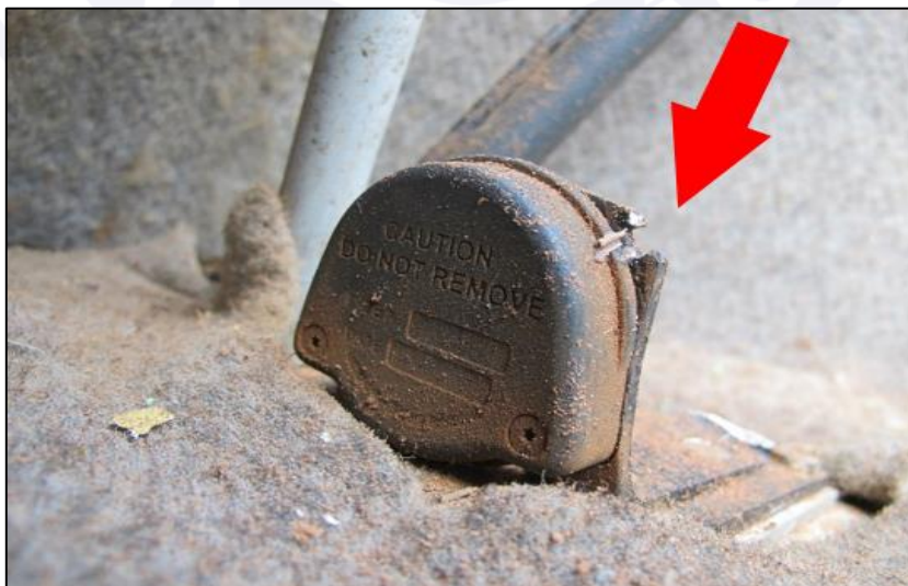
Figura 21 - Ponto de rompimento do cinto de ombro.
