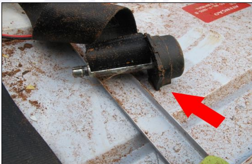
Figura 20 - Ponto de rompimento do cinto de ombro.
