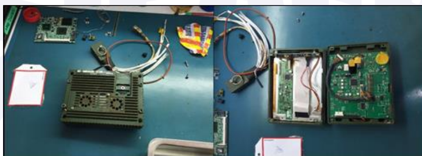
Figura 22 - Abertura do DGPS no laboratório da empresa DGPS & Cia, representante da AG-NAV no Brasil.
