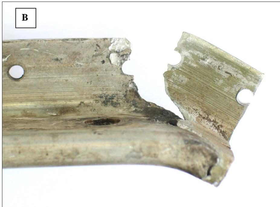
**Foto 2 (A) e (B)** – Fotografia (A) apresenta a vista geral da secção como recebida e a (B) o detalhe da região de fratura. Observam-se marcas de praia, indicativas de fadiga, com início nos orifícios de fixação dos parafusos (setas).
