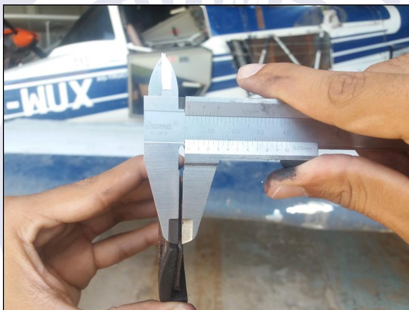
Figura 4 - Outra pastilha do conjunto de freio direito medindo 1,55mm de espessura.
