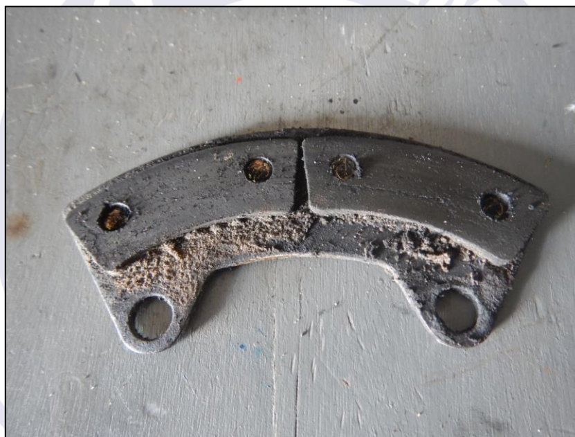
Figura 2 - Conjunto de pastilhas de freio da roda do trem de pouso direito.
