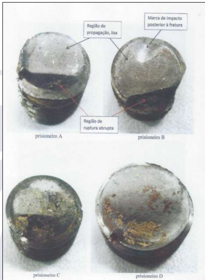
Figura 5 - Aspecto geral das superfícies de fratura dos prisioneiros. Fonte: Relatório do IAE
