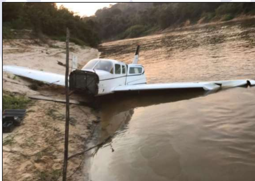
Figura 1 - Aeronave após o pouso forçado, com o conjunto do grupo motopropulsor removido sem autorização da autoridade de investigação SIPAER.
