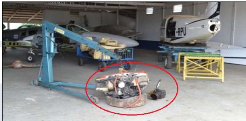
Figura 2 - Imagem da condição da aeronave encontrada durante a Ação Inicial, com destaque para o motor e o cilindro.
