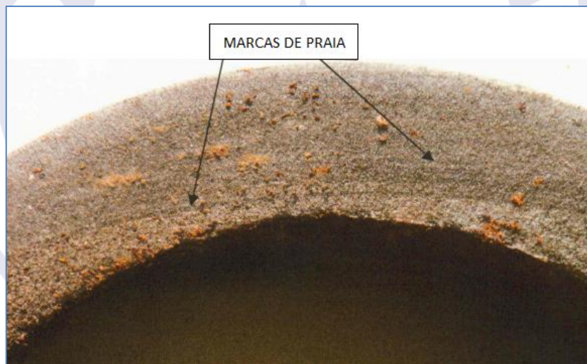
Figura 3 - Eixo de trem de pouso, com marcas de praia indicativas de fadiga.
