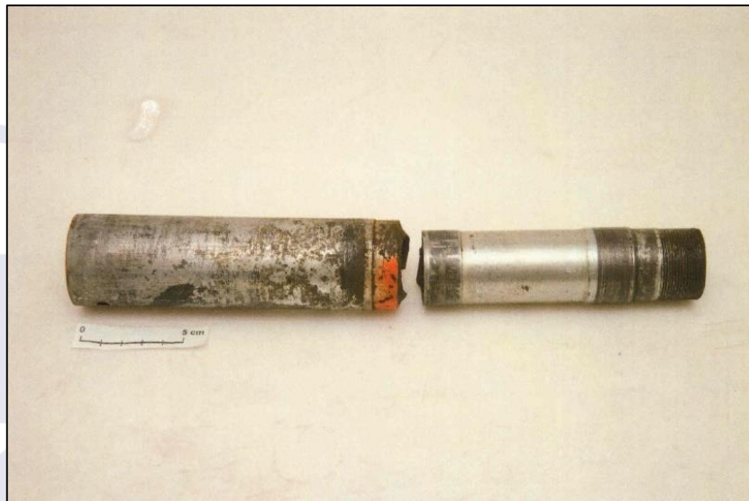
Figura 2 - Eixo axial do trem de pouso esquerdo da aeronave.
