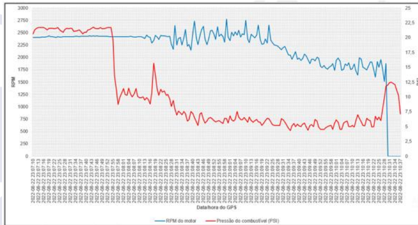
Figura 3 - Gráfico de parâmetros do motor (RPM do motor e pressão de combustível).
