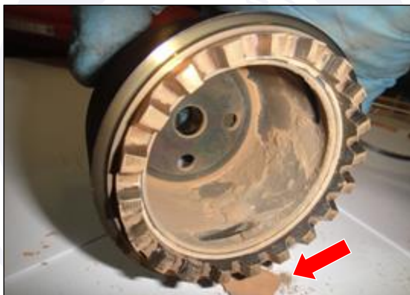
Figura 8 - Laterite desprendida da parede interna do eixo oco do módulo 3.
