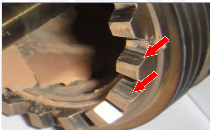
Figura 14 - Evidências da ocorrência de vibração nos dentes do acoplamento cúbico do eixo oco do módulo 3.
