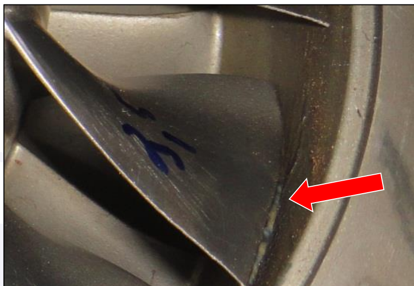
Figura 5 - Marcas de atrito entre as palhetas e a carcaça do compressor axial.
