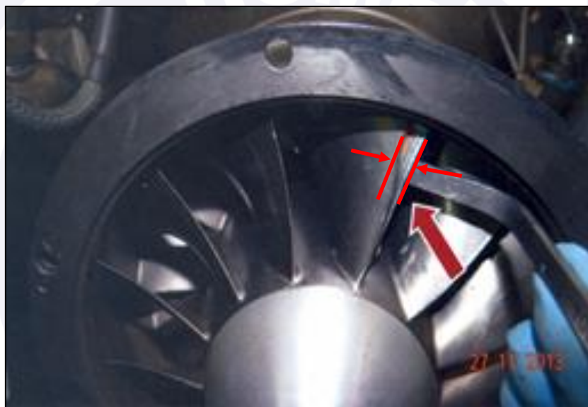
Figura 6 - Desgaste no bordo de ataque das palhetas do compressor axial.
