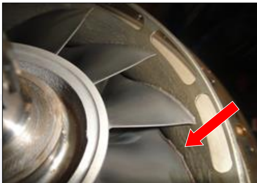
Figura 7 - Danos no impelidor do compressor centrífugo.
