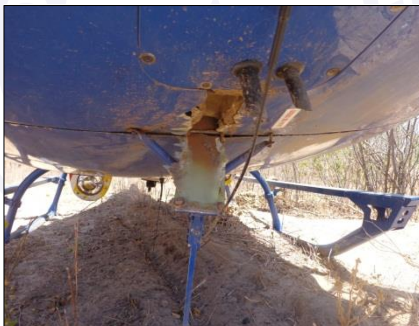
Figura 2 - Dano no corta fios inferior da aeronave.
