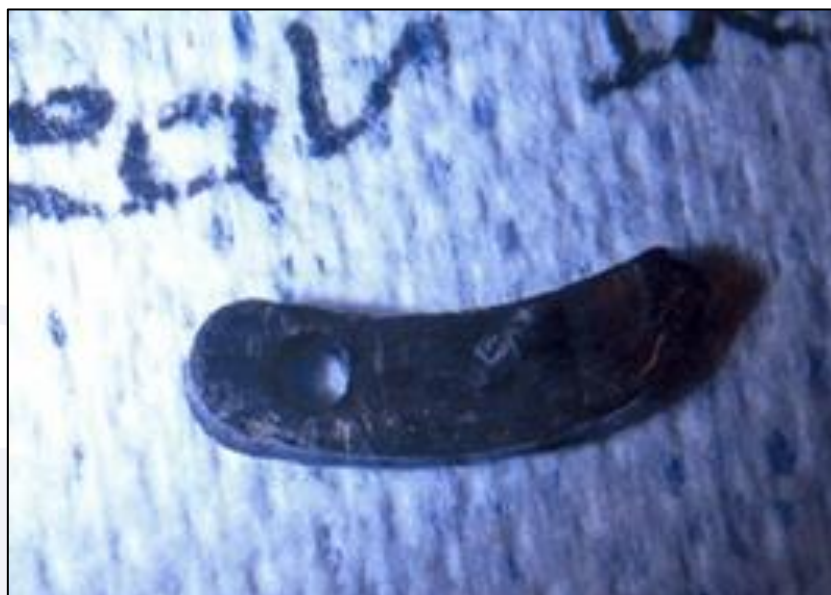
Figura 13 - Fragmento do anel-trava encontrado no sistema de lubrificação do motor.
