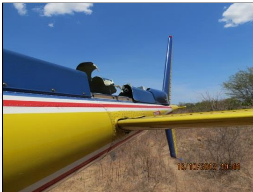
Figura 3 - Vista dos danos no boom de cauda da aeronave.
