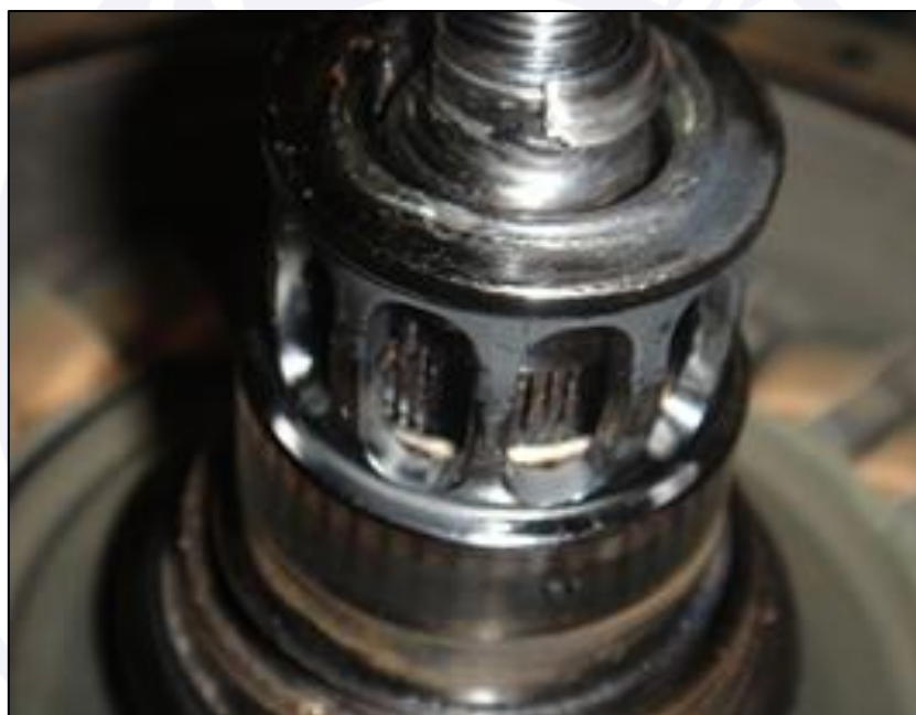
Figura 10 - Indício de superaquecimento no rolamento do gas generator .
