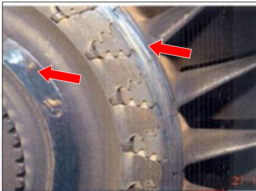
Figura 9 - Marcas de atrito no rotor da turbina.
