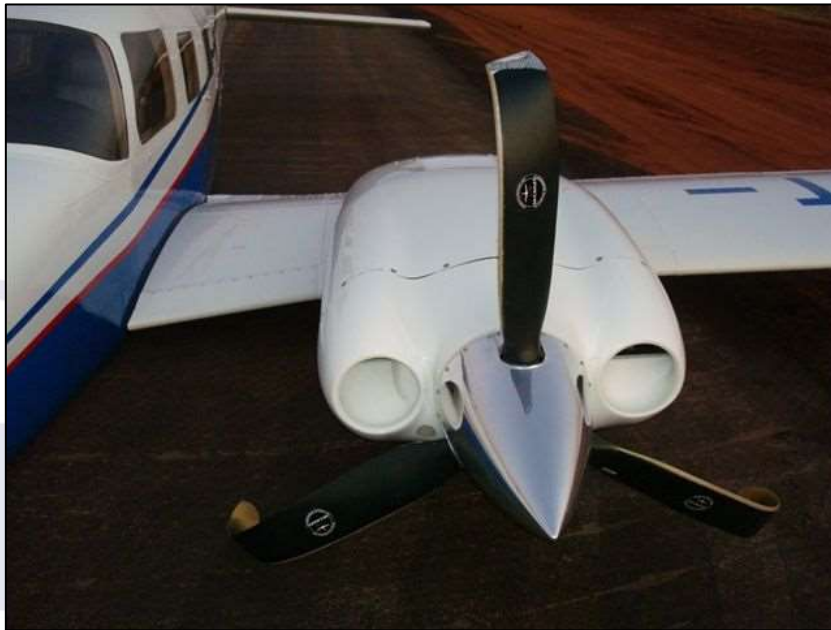
Figura 3 - Danos à hélice do motor esquerdo da aeronave.
