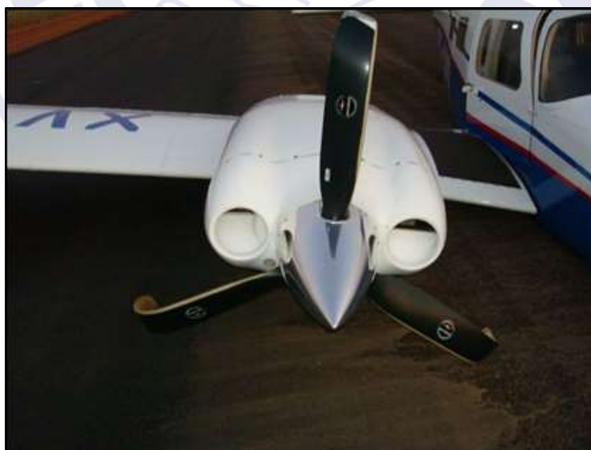
Figura 2 - Danos à hélice do motor direito da aeronave.
