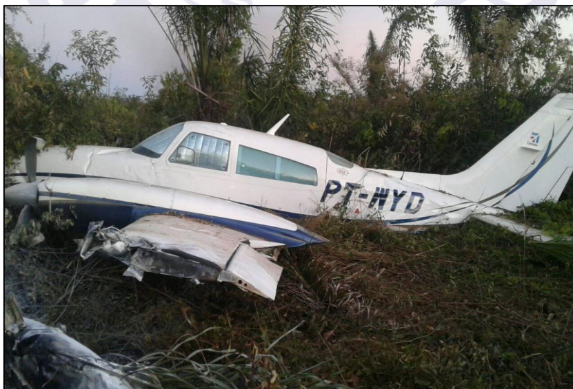
Figura 2 - Vista lateral esquerda dos danos à aeronave, após a extinção do fogo.
