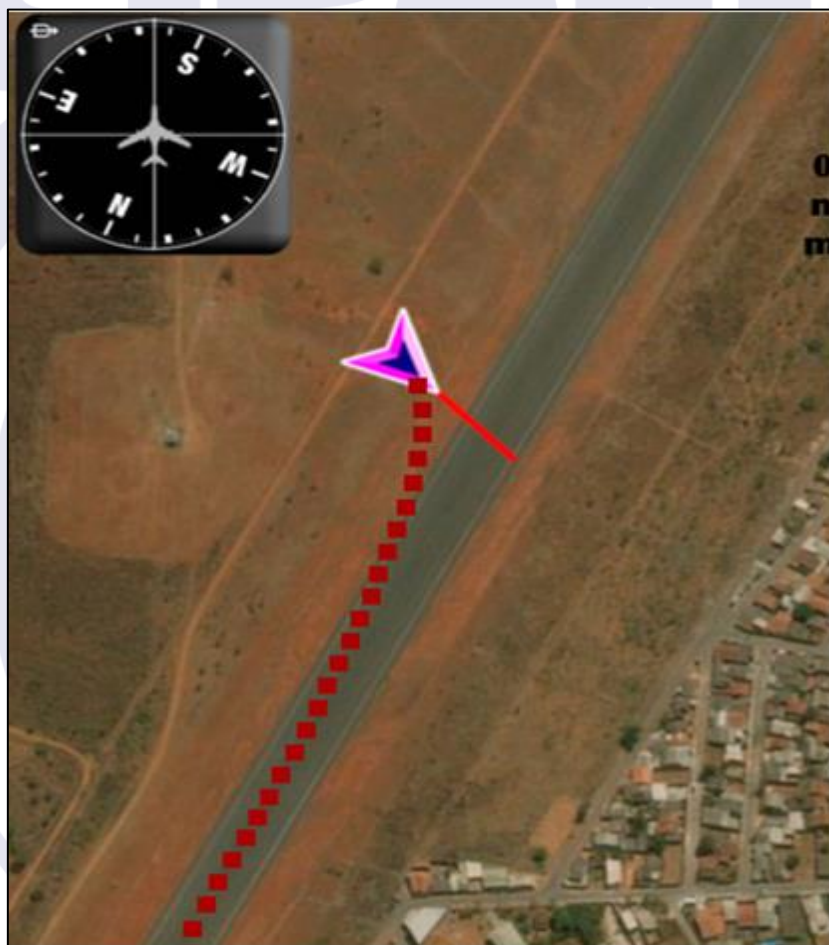
Figura 1 - PT-WLE efetuou o pouso na cabeceira 05 perdendo a reta e saindo da pista pelo lado esquerdo, fazendo um giro de 120°.
