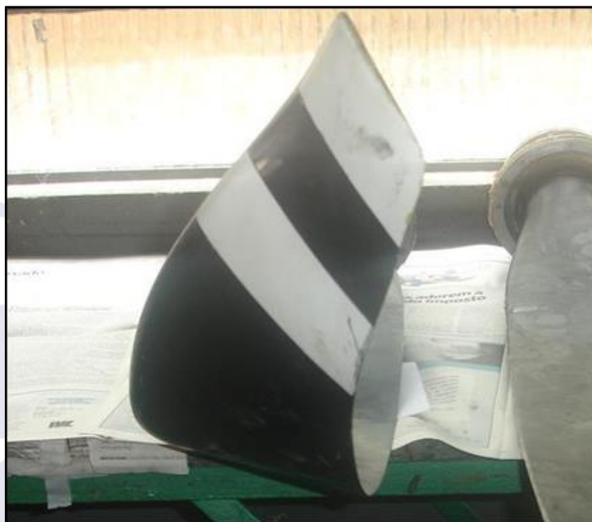
Figura 4 - Pequena torção para frente na ponta da pá.
