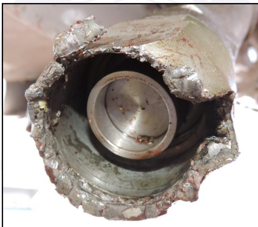
Figura 4 - Atuador do trem de pouso do nariz danificado (PN 9882020-1).
