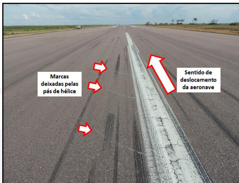
Figura 1 - Setas indicativas das marcas deixadas pelas pás de hélice na pista.
