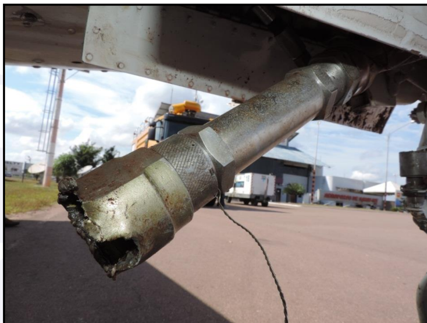
Figura 3 - Atuador do trem de pouso do nariz danificado (PN 9882020-1).
