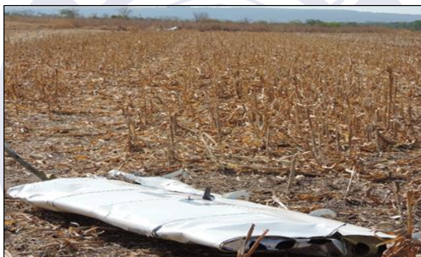
Figura 6 - Parte da raiz da asa esquerda em local distante da fuselagem.
