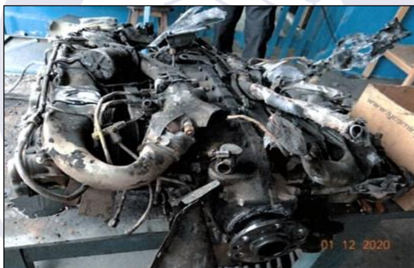
Figura 14 - Vista superior do motor esquerdo, após a ação do fogo.
