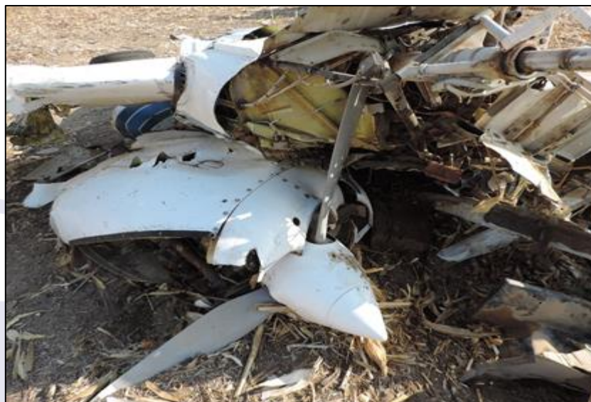
Figura 5 - Vista da hélice do motor esquerdo, com deformações típicas de impacto sem potência.
