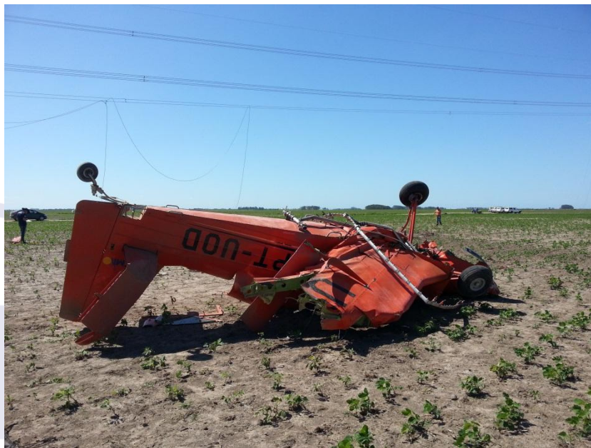
Figura 2 - Vista geral da aeronave acidentada e dos fios da rede elétrica.
