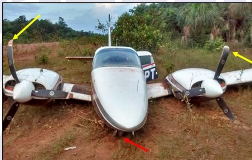
Figura 1 - Vista da aeronave após a parada total. A seta vermelha indica o trem de nariz fora do compartimento do trem de pouso. As setas amarelas indicam as deformações sofridas pelas hélices.
