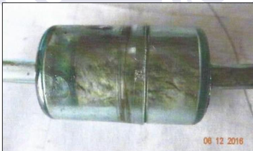
Figura 10 - Filtro de ar não previsto no manual.
