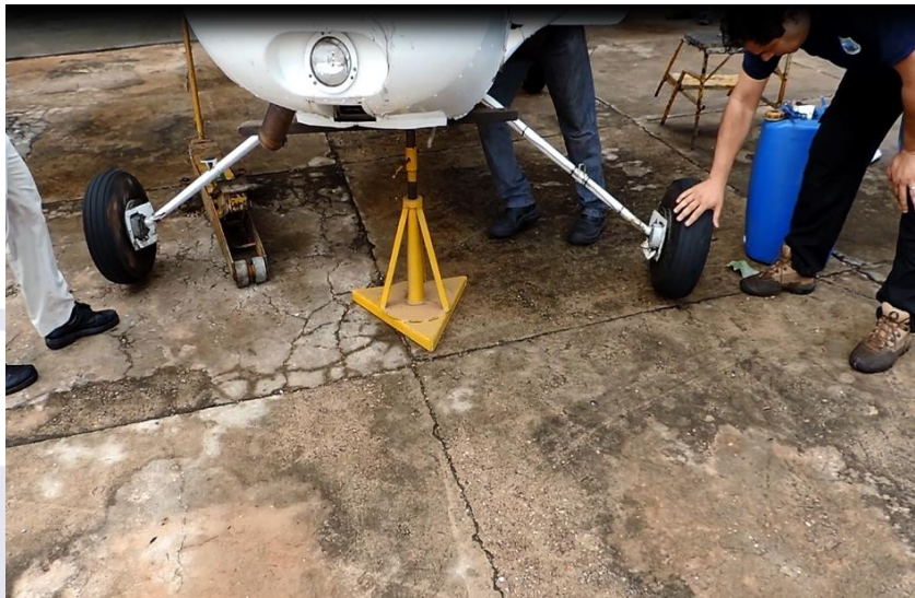
Figura 4 - Teste do conjunto de freios da aeronave.
