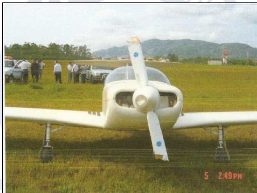
Figura 1 - Hélice danificada devido à colisão com a pista durante a corrida de decolagem.
