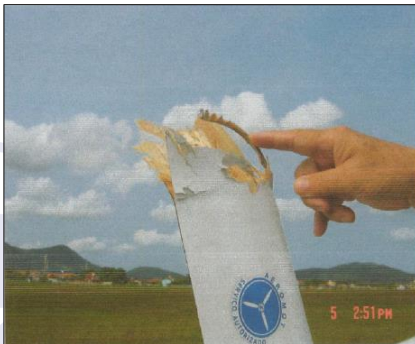
Figura 4 – Detalhe da ponta de uma das pás da hélice danificada.
