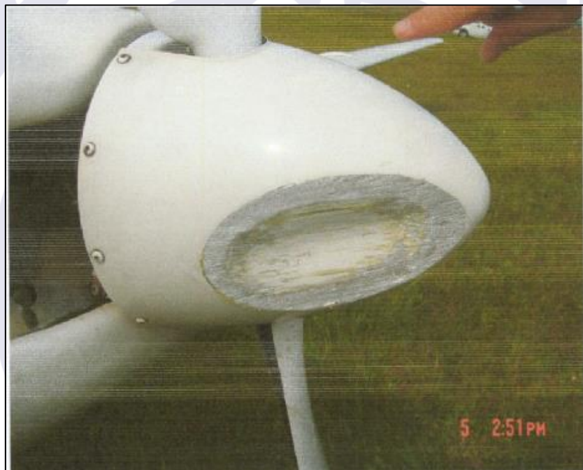
Figura 3 - Spinner danificado pelo contato com a pista.
