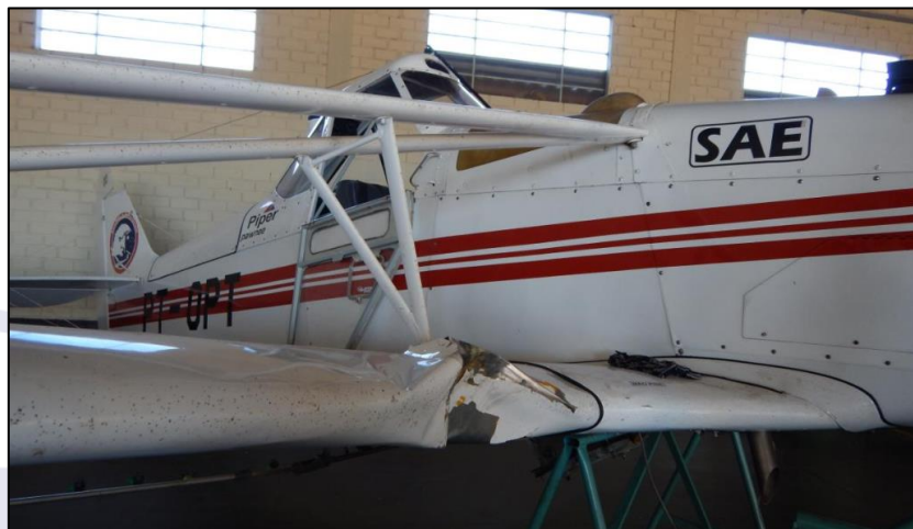
Figura 5 - Detalhe do amassamento no bordo de ataque da asa direita.
