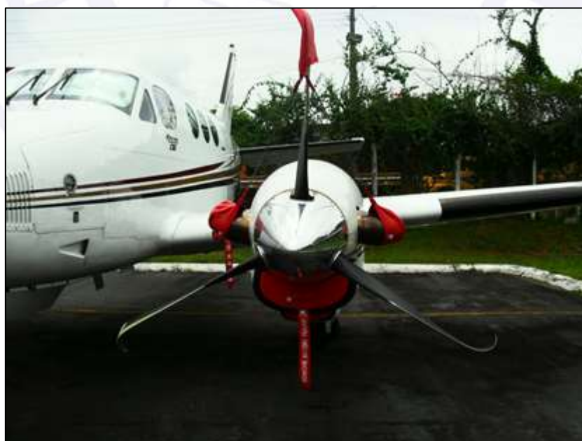
Figura 1 - Danos nas pás da hélice esquerda.
