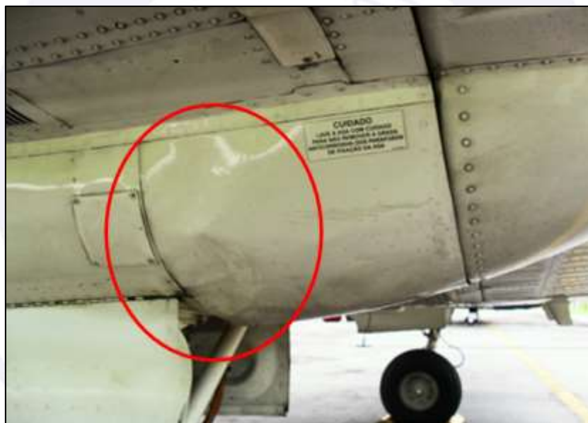
Figura 3 - Danos na carenagem do motor esquerdo.
