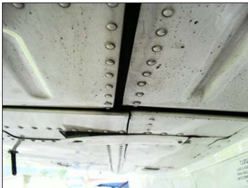
Figura 4 - Rebites soltos no intradorso da asa esquerda.
