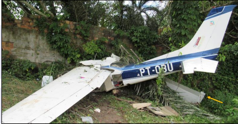
Figura 1 - Vista da aeronave após saída da pista e colisão contra o muro.
