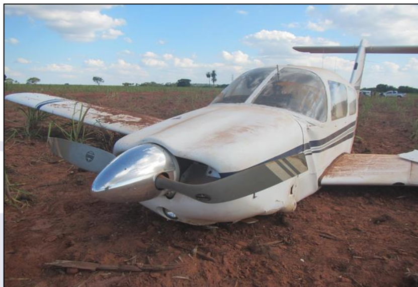
Figura 3 - Detalhe das condições das pás da hélice após o impacto.
