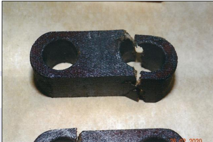
Figura 5 - Vista aproximada do link da pá menos danificada.
