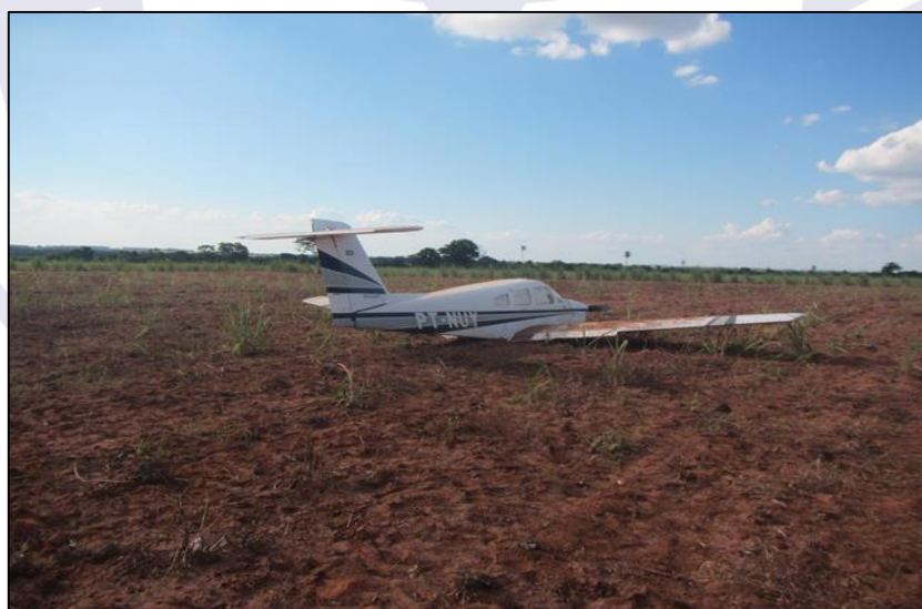
Figura 2 - Vista traseira da aeronave após o impacto. Não foi observada a presença de rastro no terreno.
