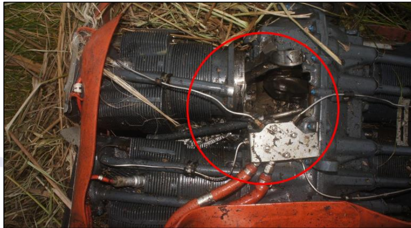
Figura 2 - Ponto de quebra do bloco do motor da aeronave.
