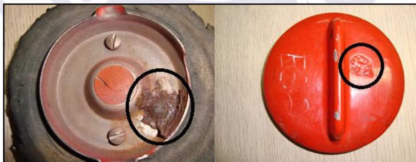
Figura 3 - Tampa de vedação do tanque esquerdo, com detalhe da vedação interna e externa sobre a válvula de alívio.
