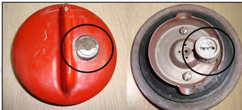
Figura 4 – Detalhe da tampa do tanque direito com vedação externa sobre a válvula de alívio e com acessório de chave não previsto pelo fabricante.
