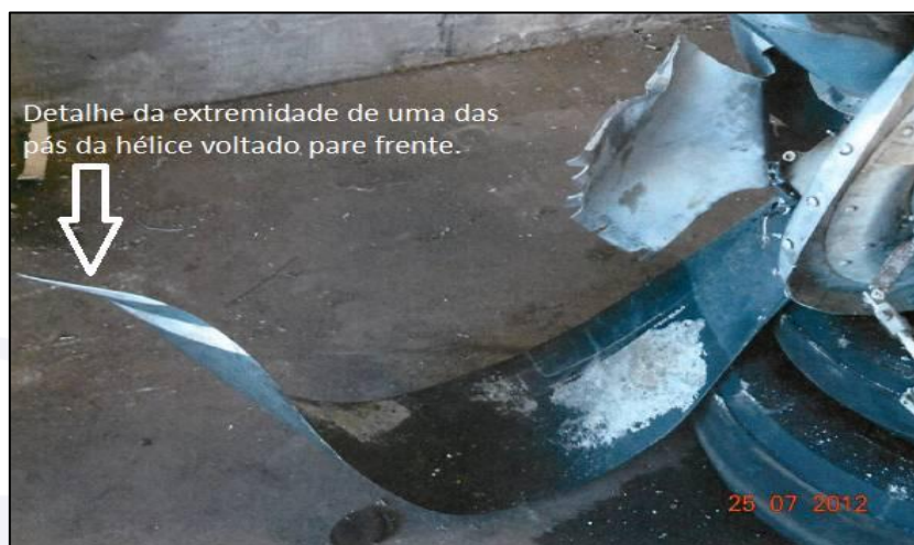
Figura 13 - Uma das pás da hélice do motor direito (#2) com dobramento voltado para frente, na sua extremidade.
