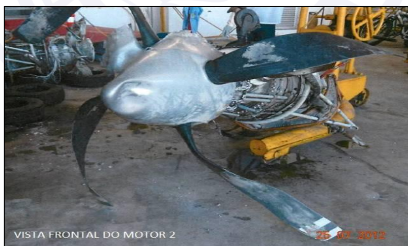
Figura 12 - Pás da hélice do motor direito (#2) com deformações.
