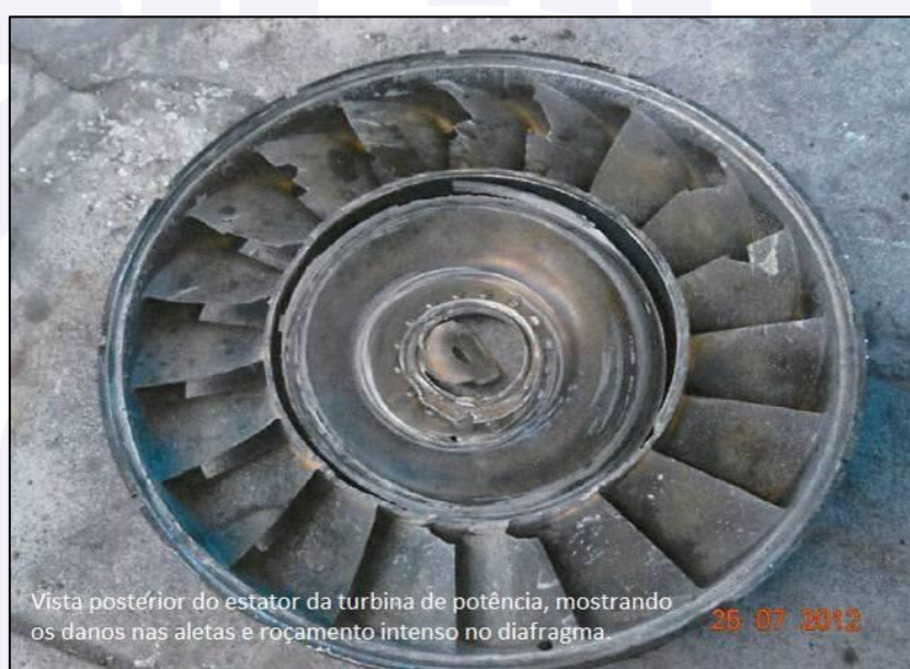
Figura 11 - Danos na turbina de potência e roçamentos no diafragma do motor direito (#2).
