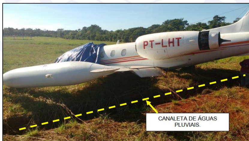
Figura 3 - Aeronave após a parada total e indicação da canaleta de águas pluviais.
