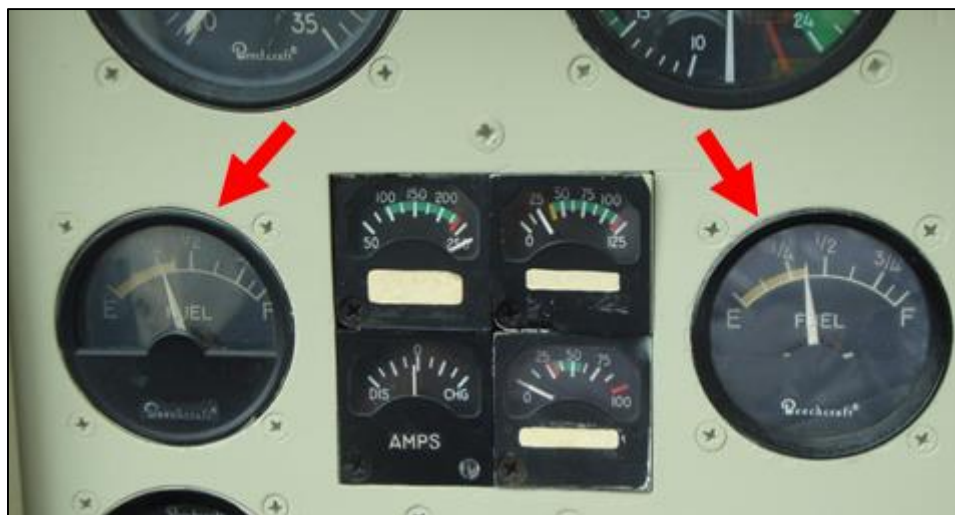
Figura 2 - Liquidômetros indicando cerca de \frac{1}{4} da capacidade total, após a pane seca.
