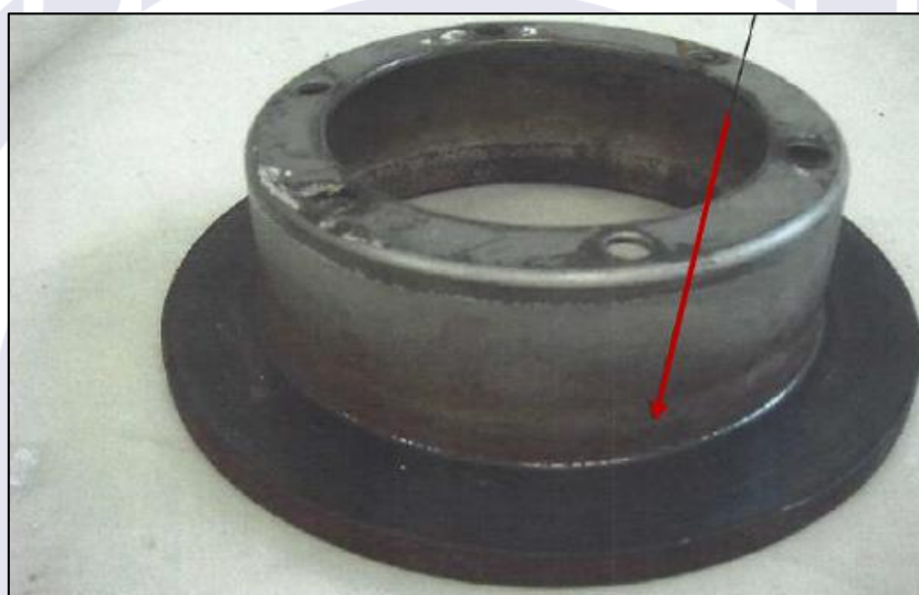
Figura 6 - Corrosão superficial no disco de freio.
