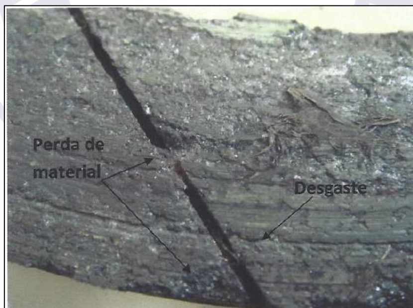
Figura 1 - Pastilha de freio esquerda com perda de material na superfície e desgaste anormal.
