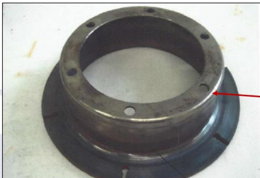
Figura 5 - Azulamento na pista do disco de freio.
