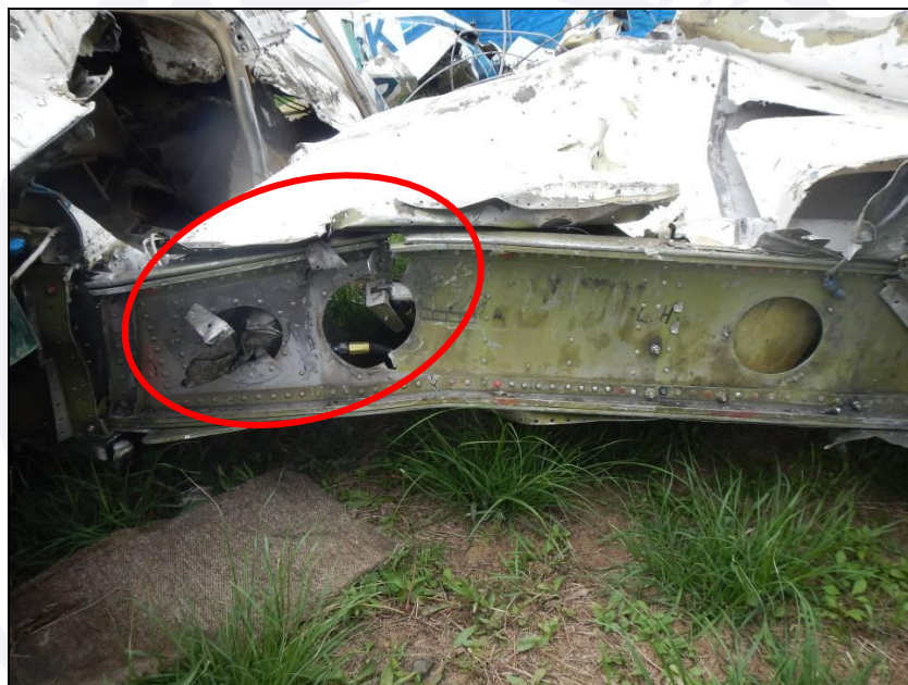
Figura 7 - Condição da longarina da asa esquerda na área de fixação da nacele do motor.
