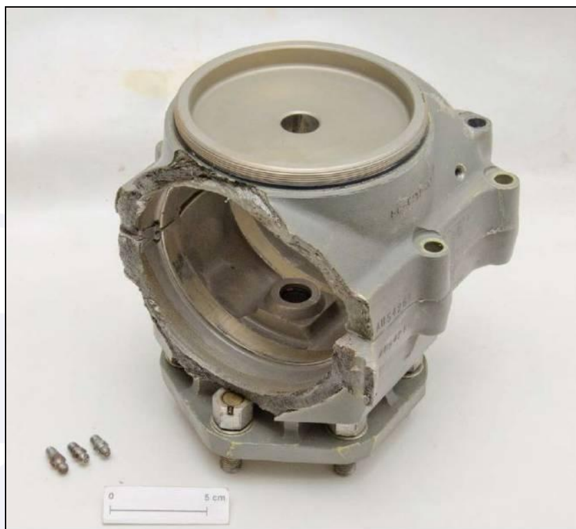
Figura 10 - Cubo de hélice enviado para análise.
