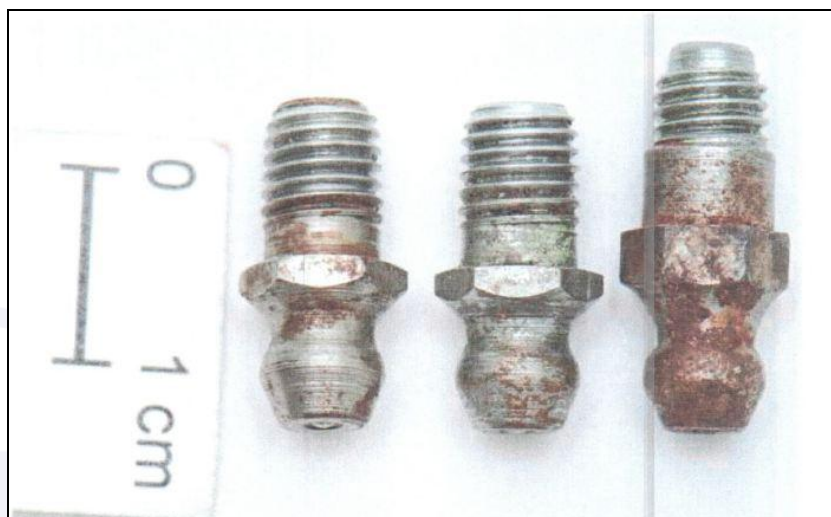
Figura 12 - Diferenças entre os pinos de engraxamento.
