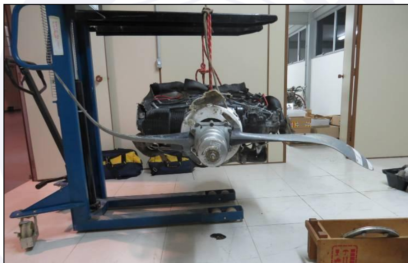
Figura 9 - Pás da hélice do motor 2 empenadas.
