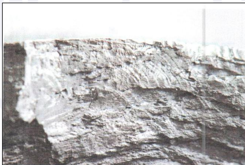
Figura 11 - Superfície de fratura do cubo de hélice com características de fadiga.
