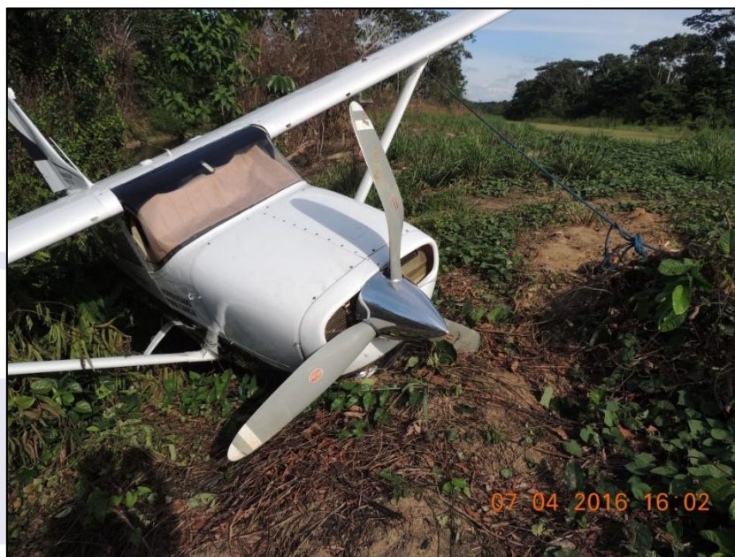
Figura 4 - Imagem frontal da aeronave com visão da hélice danificada.
