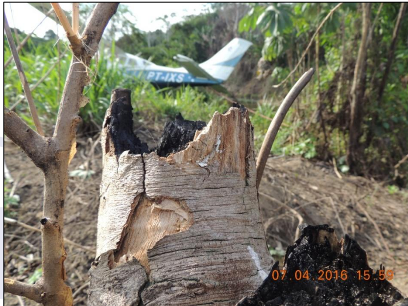
Figura 2 - Parte da vegetação onde a aeronave colidiu durante a derrapagem. Ao fundo, observa-se o ponto final de parada da aeronave, próximo a um barranco.
