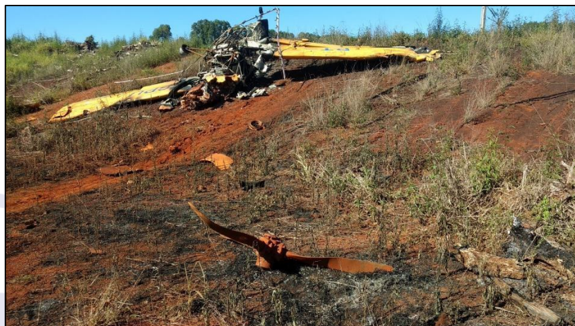
Figura 5 - Imagem mostrando a posição em que foram encontrados a hélice e o avião.
