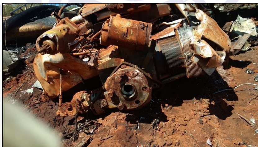
Figura 7 - Detalhe do flange que ligava o eixo do motor à hélice.
