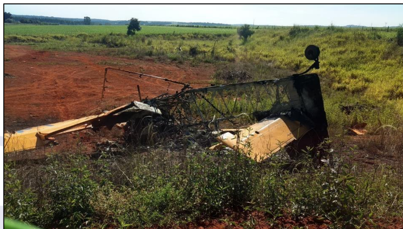
Figura 3 - Imagem da aeronave mostrando a fuselagem consumida pelo fogo.
