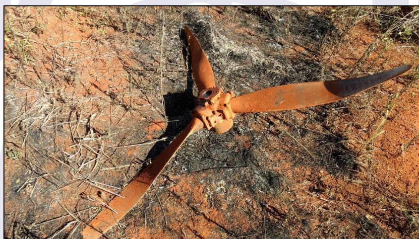
Figura 6 - Imagem mostrando, em detalhes, as deformações das pás da hélice.
