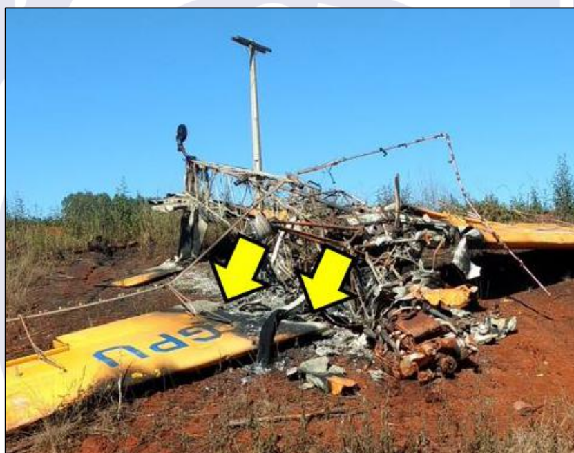
Figura 4 - Imagem da asa esquerda exibindo marcas de fogo oblíquas.
