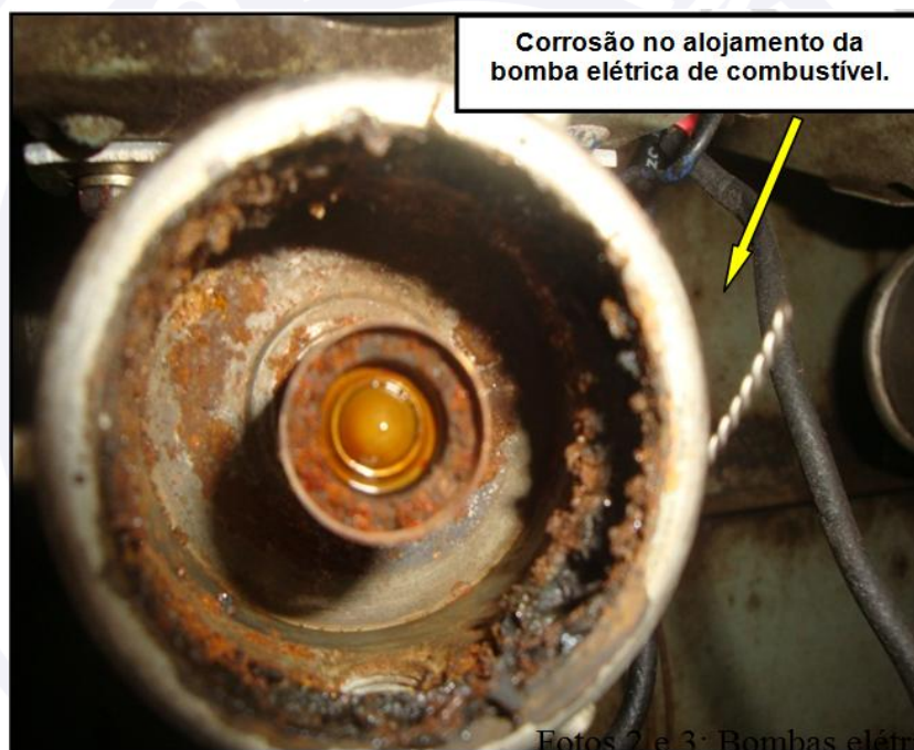
Figura 3 - Corrosão no alojamento da bomba.
