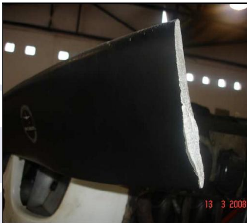
Figura 4 - Detalhe da pá fraturada.
