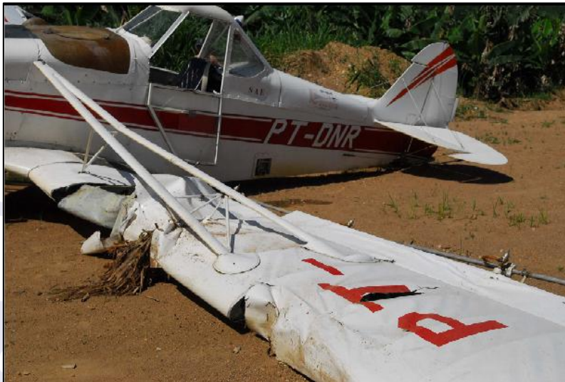
Figura 2 - Detalhe dos danos à asa esquerda.
