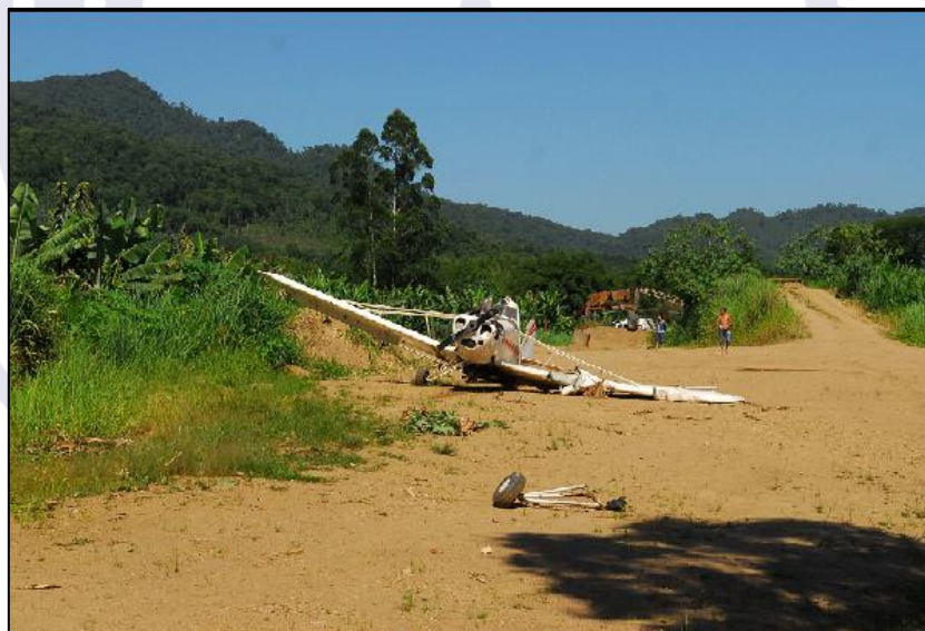
Figura 1 - Vista frontal da aeronave e dos danos ao trem de pouso e asa.
