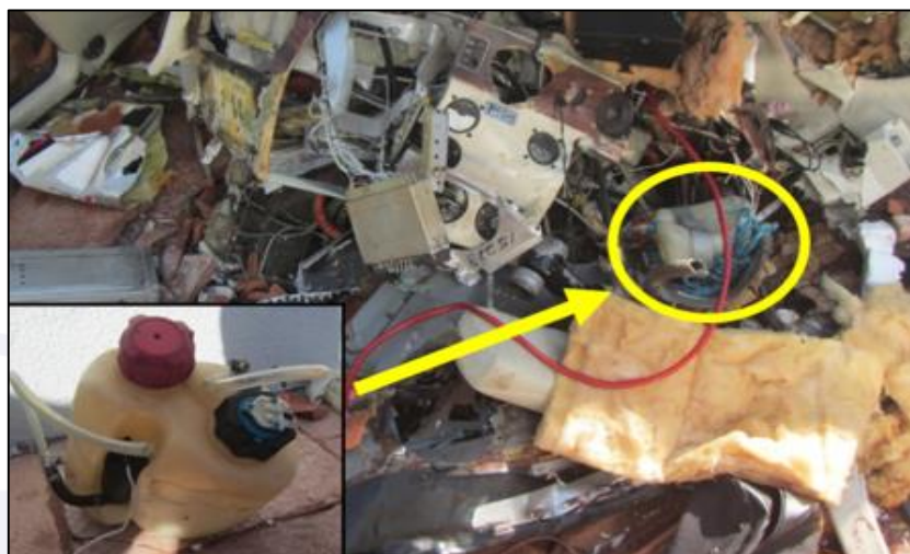
Figura 5 - Reservatório do sistema de "partida a frio".
