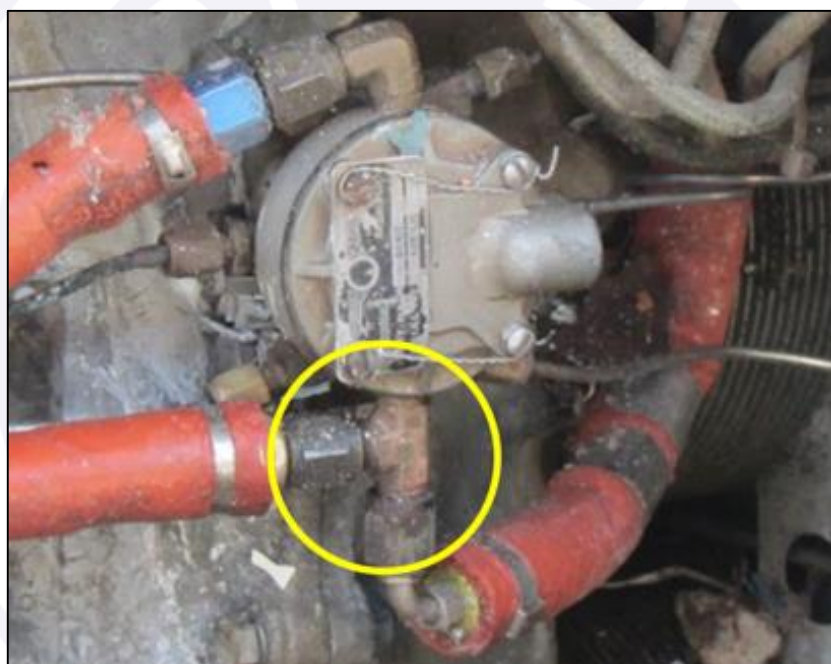
Figura 4 - Distribuidora com nipple de derivação na entrada de combustível.
