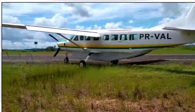
Figura 1 - Vista geral do PR-VAL após a saída de pista ( veer off ).
