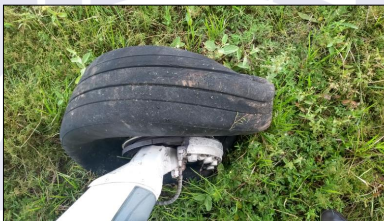
Figura 2 - Danos no pneu esquerdo, após saída lateral de pista.
