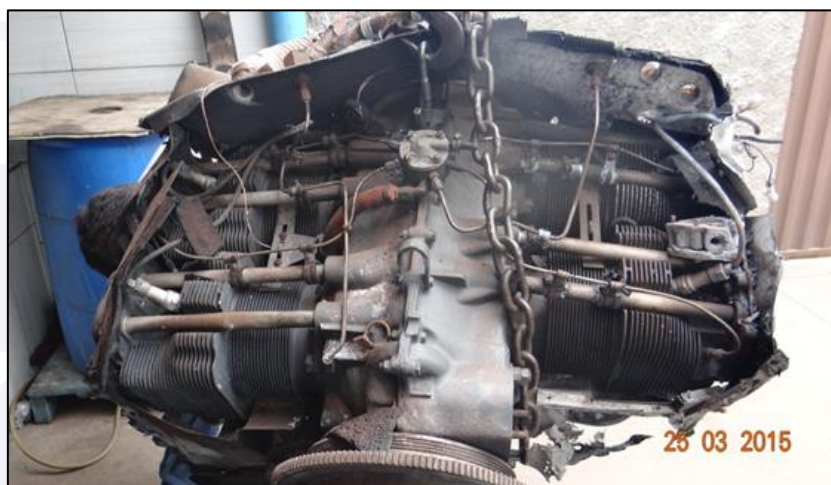
Figura 2 - Vista superior do motor Lycoming IO-360-L2A, n/s L-27055-51A.
