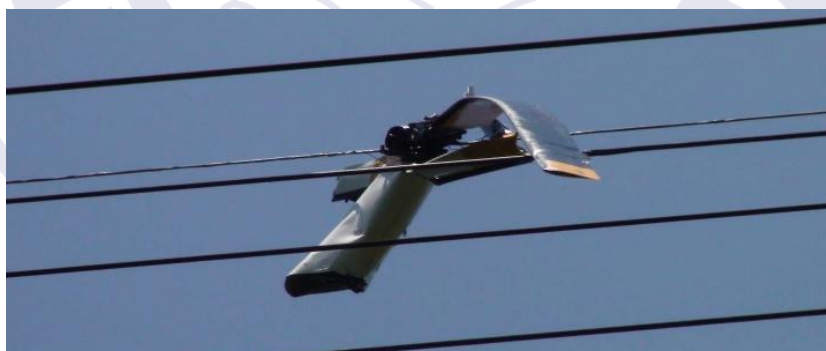
Figura 2 - Rotor principal preso no cabo de aço da rede de alta tensão.
